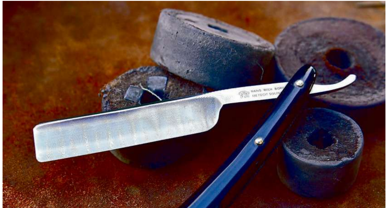
Rasiermesser werden in traditioneller Handarbeit meist aus Kohlenstoff-Stahl gefertigt.
